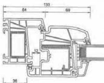
La porte avec l'ouvrant de 97 est réalisable en dormant neuf ou rénovation, ouvrant **droit ou design**.
