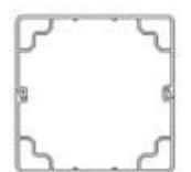
POTEAU SECTION 200x200mm (à sceller ou poser sur platine)
